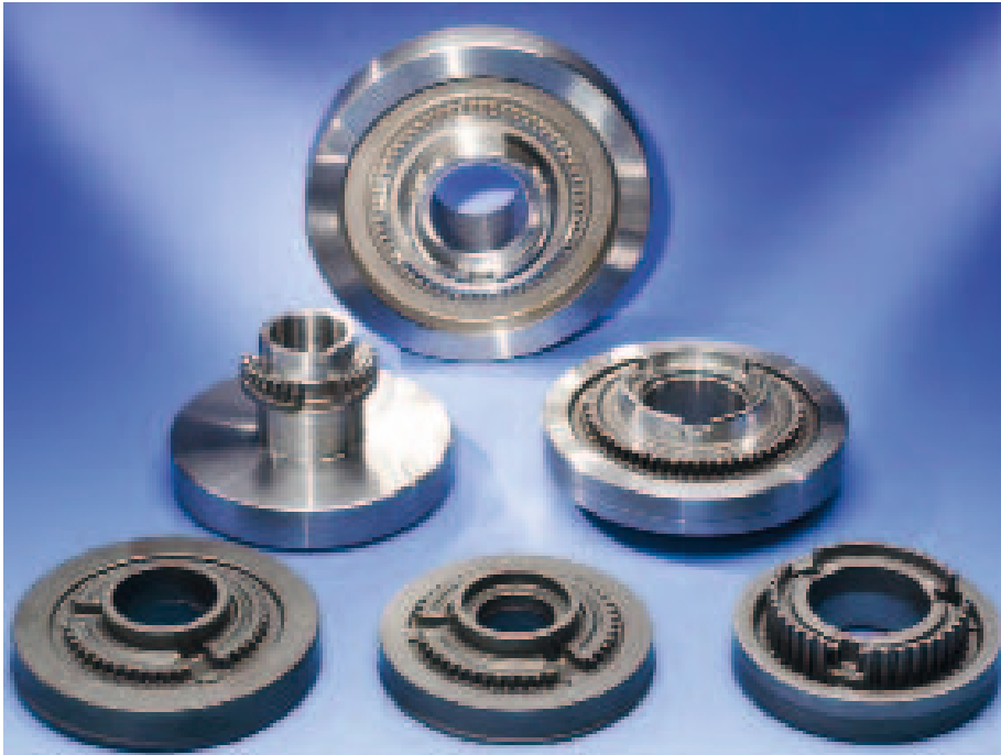
Zahnräder mit angeschmiedeter, einbaufertiger Kuppelverzahnung: Weitere Vorteile sind eine 25 % höhere Zahnfußfestigkeit und reduzierte Bauhöhe.
