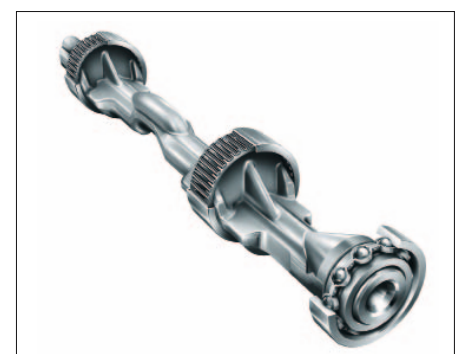
Diese geschmiedete Ausgleichswelle ist 33 % leichter als der gegossene Vorgänger. Induktiv gehärtete Lagerflächen ermöglichen Nadellager ohne Innenring. Bild: Schaeffler KG/Hirschvogel
