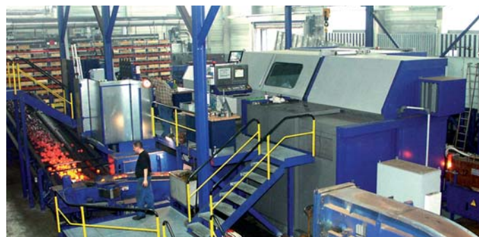
Bild 6: Hatebur Hotmatic HM 45: Mit einem Ausstoß von bis zu 150 Schmiedeteilen pro Minute lässt sich mit der ultraschnellen Warmpresse eine Vielfalt an Präzisionsschmiedeteilen äußerst wirtschaftlich herstellen. Bild: Seissenschmidt
