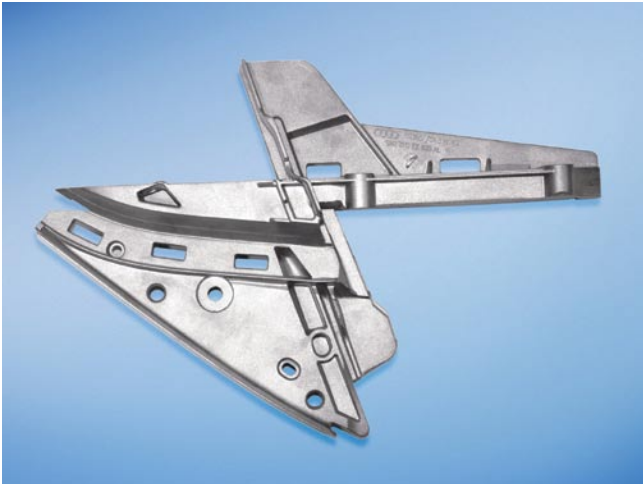
BILD 2 Substitution: Beim Auto zählt jedes Kilo Gewichtseinsparung. Dieses mit Hilfe des innovativen Thixoforming-Verfahrens erzeugte Aluminium-Knotenelement für eine Autotür kann besonders hohe Kräfte aufnehmen (Bild: Infostelle Industrieverband Massivumformung e. V., Schmiede-Journal März 2008)
