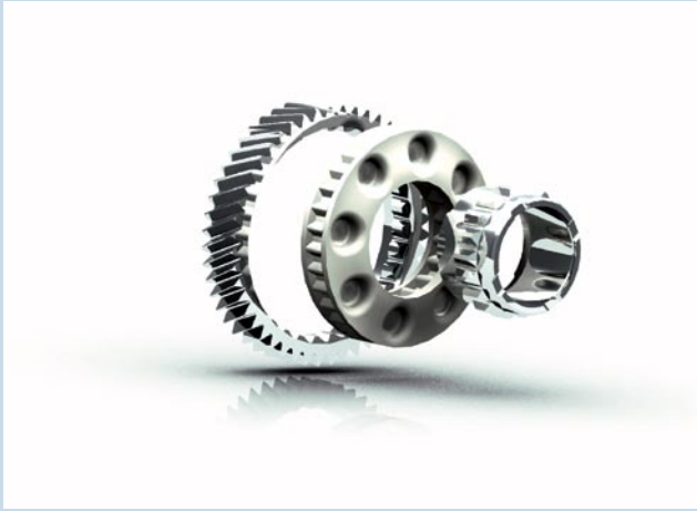
BILD 10 Diese innovative Zahnrad-Verbundkonstruktion aus zwei verschiedenen Stählen sowie Aluminium ermöglicht eine Gewichtseinsparung von 5-10% (Bild: Neumayer Tekfor)
