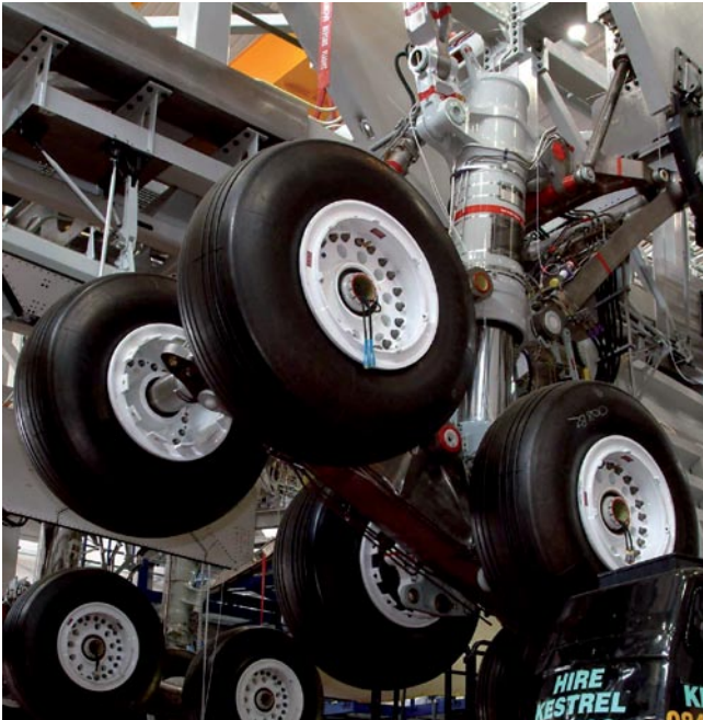
BILD 1 Im Fahrwerk von Passagierflugzeugen - hier das Hauptfahrwerk des A 380 im Test - widerstehen geschmiedete Sicherheitsteile aus hochfesten Vergütungsstählen bei Start und Landung extremen dynamischen Belastungen (Bild: Airbus)
