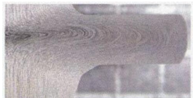
BILD 5 Der Umformprozess erzeugt im Bauteil eine Faserstruktur, welche die Belastbarkeit in Richtung der Fließlinien des Werkstoffs erhöht (Bild: Hirschvogel Automotive Group)
