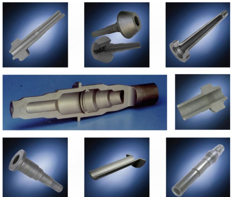
Bild 1: Bauartenvielfalt von Hohlwellen für Getriebeanwendungen
