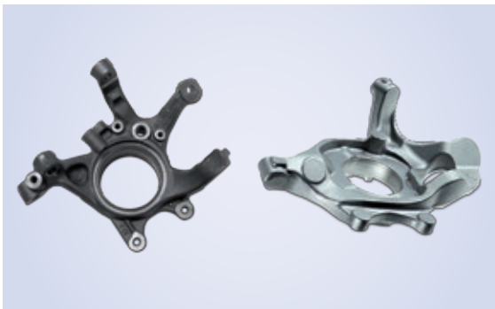
Abbildung 5: Pkw-Hinterachsradträger – links: Stahlausführung, rechts: Nachfolgeneration aus Aluminium mit verringertem Systemgewicht
