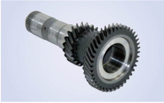
Abbildung 35: Antriebswelle – Realbauteil im ausgebauten Zustand
