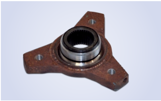
Abbildung 39: Anschlussflansch der Kardanwelle im ausgebauten Zustand
