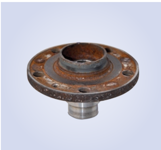
Abbildung 37: Radlager vorne links im ausgebauten Zustand
