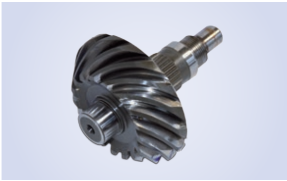
Abbildung 31: Stirnradwelle des Verteilergetriebes – Realbauteil im ausgebauten Zustand
