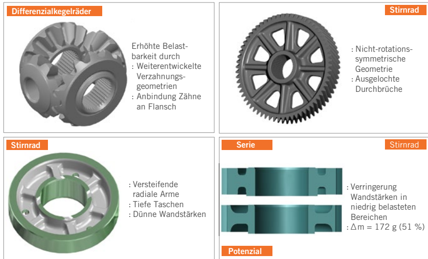
7 Leichtbaupotenziale an Getriebebauteilen (Quellen: Metaldyne, metallumform, Seissenschmidt, Sona BLW Präzisionsschmiede)
